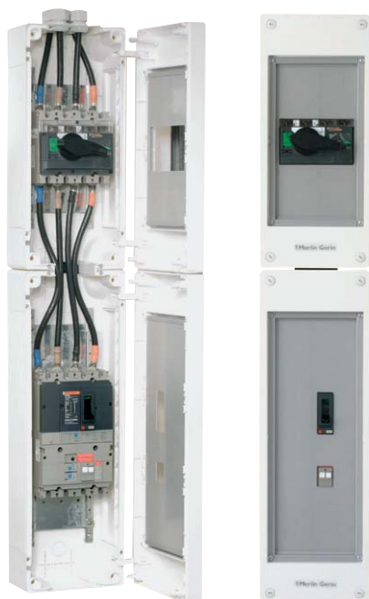
Пример установки Interpact INV + Vigicomact в 2 интерфейсных шкафах. Необходимые компоненты: интерфейсные шкафы PRA06224 и PRA06324 + комплект «Interpact» PRA90068 + комплект «Vigicomact» PRA90069 + комплект для присоединения 04149
